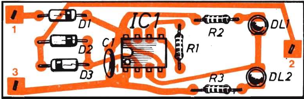
Fig. 2 - Esempio di montaggio della sezione elettronica della sonda logica. Si notino le presenze degli elementi di riferimento per l'individuazione del verso di inserimento nel circuito dei tre diodi al silicio, dei due diodi led e dell'integrato.
